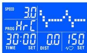
Programmieren Sie die Zielsetzung Pulsschlag (THR= Target Heart Rate) mit  $\wedge/\vee$  und ENTER.
