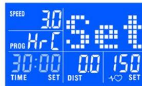
Drücken Sie auf auf START um mit dem Training anzufangen. Das Laufband wird 2 Minuten mit einer Geschwindigkeit von 3 km/Stunde bewegen (zum aufwärmen), die Steigung (Inklination) können Sie manuell ändern.
