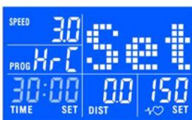
Presione START: la cinta correrá a una velocidad de 3 kmh durante 2 minutos para calentar: Ajuste la elevación de manera manual.
