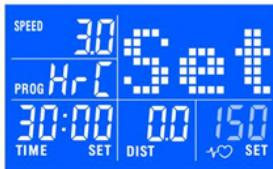
Programma per il tempo totale di esercizio e la distanza con ^/v, e premendo ENTER.
