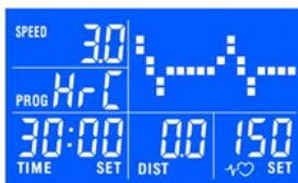
Programmeer de doel hartslag (THR, of target heart rate) met  $\wedge/\vee$ , en bevestig via ENTER.
